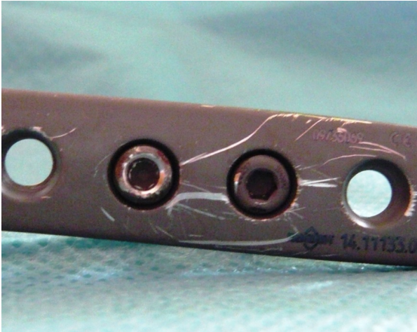
Winkelstabile Platte mit ausgedrehtem Schraubenkopf
